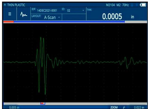
使用72DL PLUS超声测厚仪和125 MHz M2104偏移水浸探头进行模式2测量（从前表面到底面回波）获得的薄塑料膜的厚度值为0.013毫米。
